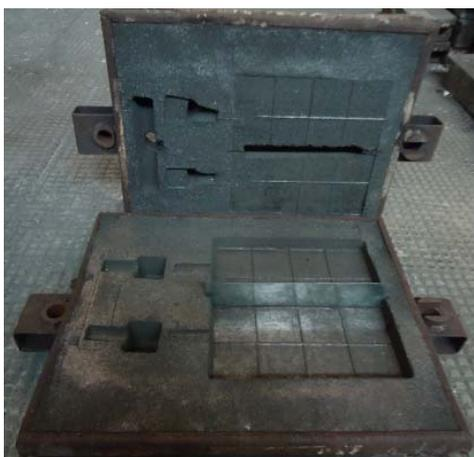
Рис. 2. Общий вид литейной формы со вставленной в полость формы вертикальной перегородкой из оцинкованного железа
