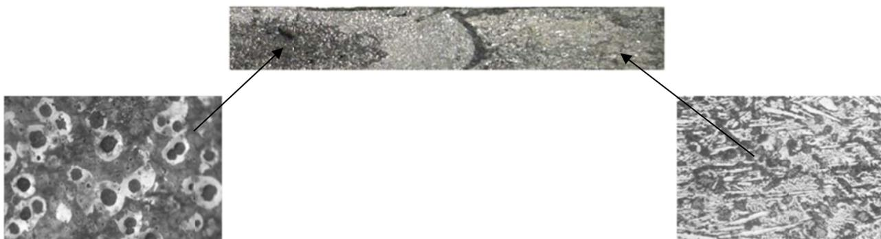
Рис. 3. Результаты исследований структуры двухсторонней отливки:
