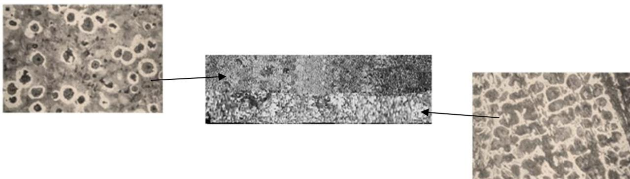
Рис. 4. Результаты исследований структуры двухслойной отливки:
